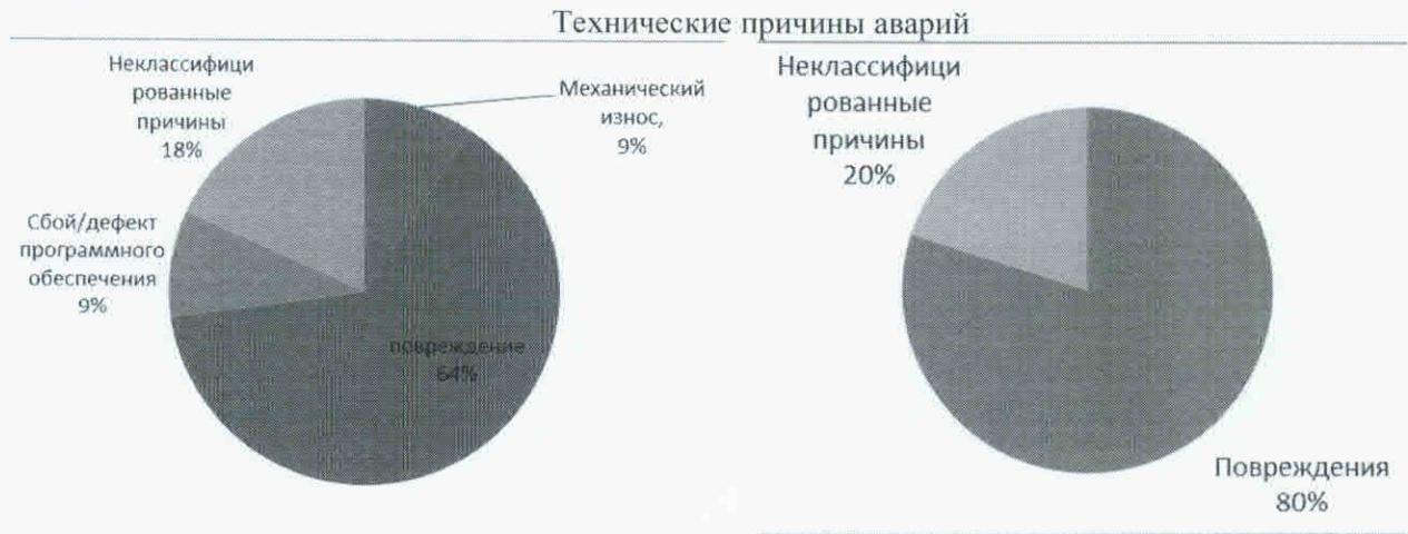
**Вывод:** основной технической причиной аварий 2017 года по-прежнему являются механические повреждения оборудования.
